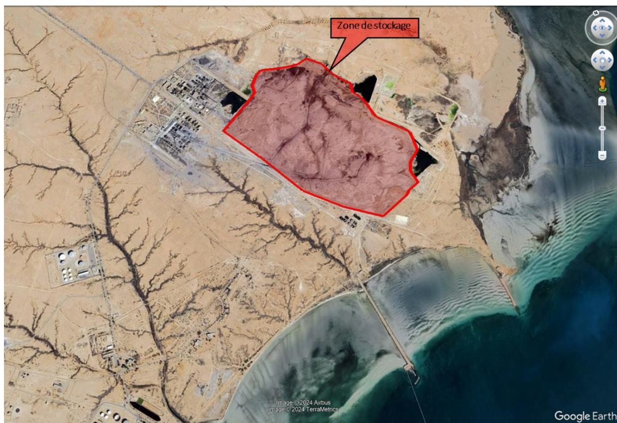
**Figure 6-12 : Zone de stockage de phosphogypse pour l'usine de Skhira**
